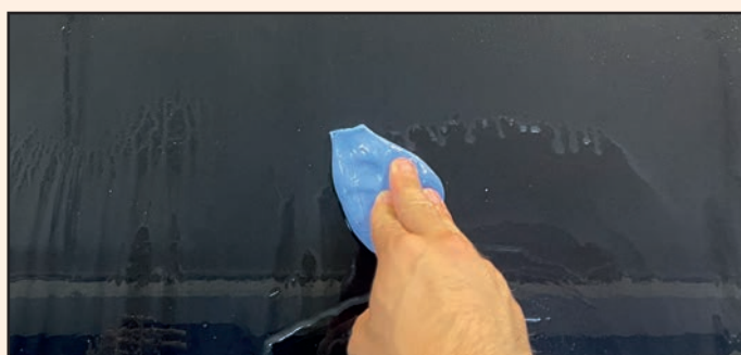
... wurde mittels Knete der Restschmutz entfernt ...
