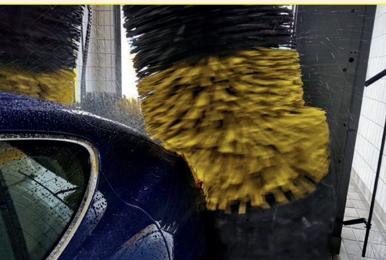
Bürstenwäsche Segment für Segment. Exakte Anpassung der Bürsten an die Fahrzeugkontur. Sehr gute Reinigungsergebnisse auch bei schwierigen Fahrzeugkonturen.
